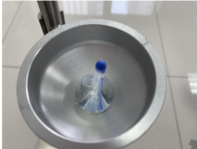
图6 拉力作用下球囊未被拉进漏斗状装置
