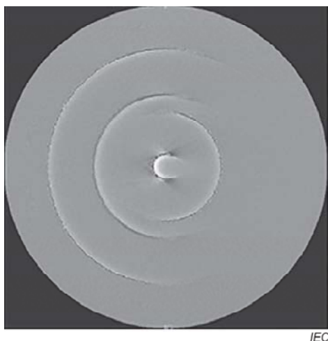
图F.1-轴向层面显示模体的PMMA区域的环状伪影
