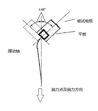
图1 电极线稳固性测试示意图
